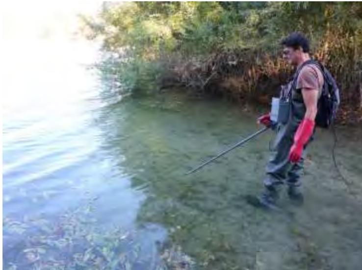
Abbildung 6: Elektrobefischung mit dem batteriebetriebenen Gerät.
