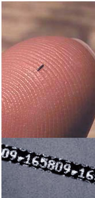
Coded Wire Tag (CWT) im Größenvergleich und in Vergrößerung
